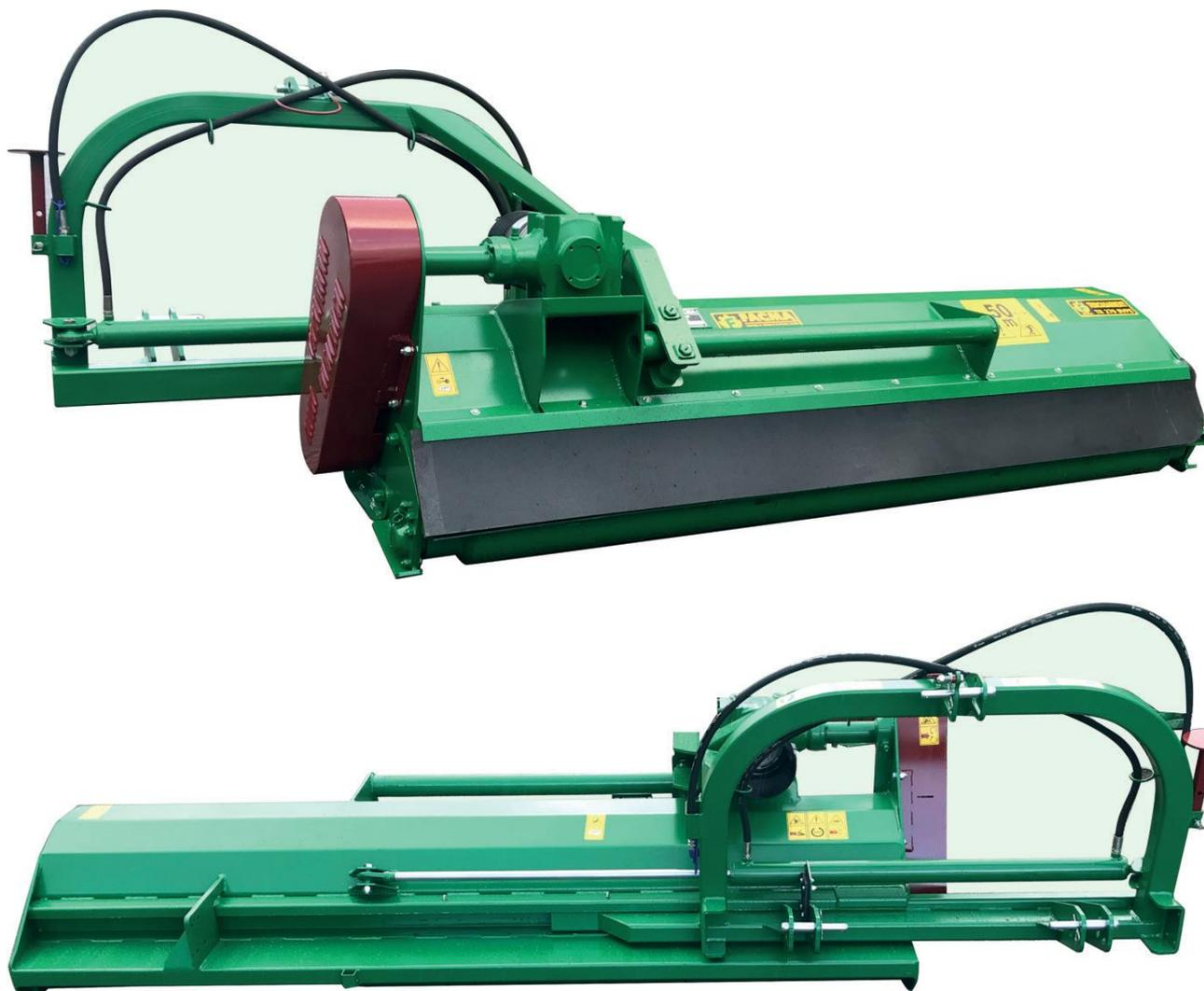
Il modello VPE è indicato per la trinciatura di erba, sarmenti, residui di potatura e pietre muovibili di medie dimensioni (fino a 12 cm di diametro). Cofano in lamiera anti-usura domex, acciaio strutturale alto resistenziale.
